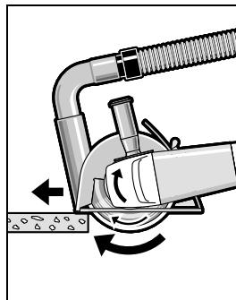
开动电动工具, 并把导引装置的前端放置在工件上。参考工件的物料, 适当地施力推进机器。
