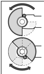
将防護罩 6 套在軸頸上。請依據工作過程中的需求，配合調整防護罩 6 的位置。若欲固定住防護罩 6 的位置，請用十字螺絲起子鎖緊止付螺絲 5。
