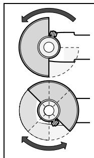
Montez le capot de protection **6** sur le collet de broche. Ajustez la position du capot de protection **6** en fonction des besoins. Bloquez le capot de protection **6** en serrant la vis de serrage **5** avec un tournevis cruciforme.
