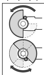
Coloque a capa de proteção **6** na gola do veio. Ajuste a posição da capa de proteção **6** de acordo com os requisitos da operação. Fixe a capa de proteção **6** apertando o parafuso de fixação **5** com uma chave Phillips.
