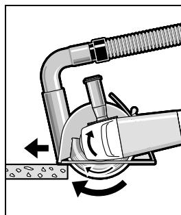
เมื่อเครื่องทำงาน และ วางส่วนหน้าของแผ่นสำหรับ การดูดฝุ่นบนงาน เคลื่อน เครื่องมือข้ามหน้าตัดวัย ความเร็วพอประมาณที่ เหมาะกับลักษณะงานที่ กำลังตัดอยู่ เมื่อตัดวัสดุที่แข็งเมิน พิเศษ ต. ย. เช่น คอนกรีตที่มีกรวด ผลไม้สูงมาก งาน ตัดเพชรจะร้อนเกินไป และด้วยเหตุนี้จะชำรุด
