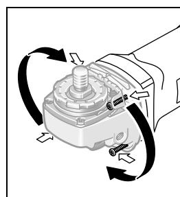
O cabeçote de engrenagens pode ser girado em passos de 90°. Desta forma o interruptor de ligar-desligar pode ser colocado numa posição de manuseio mais favorável para tarefas especiais, como por exemplo no caso de esquerdinos. Desatarraxar completamente os 4 parafusos. Deslocar o cabeçote de engrenagens cuidadosamente, e sem retirar da carcaça, para a nova posição. Reapertar os 4 parafusos.
