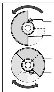
Letakkan kap pelindung **6** pada leher poros. Cocokkan posisi kap pelindung **6** pada pekerjaan yang dilakukan. Kencangkan kap pelindung **6** menggunakan baut pengunci **5** dengan obeng kembang.
