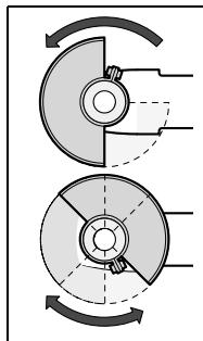
把防护罩 6 安装到主轴上。根据工作需要调整好防护罩 6 的位置。接着再使用固定螺丝 5 锁定防护罩 6。
