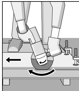
เครื่องต้องทำงานใน ทิศทางตรงกันข้ามกับ การหมุนเลื่อน มีฉะนั้น จะเกิดอันตรายจาก การที่เครื่องถูกดันออก จากร่องตัดโดย ความคุณ ไม่ได้
