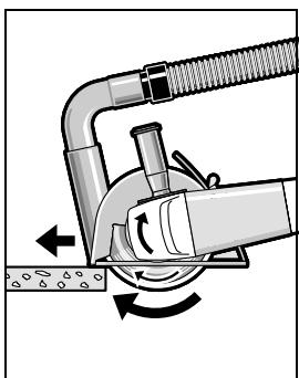
Mettez l'outil électroportatif en marche et positionnez-le avec la partie avant de la glissière de guidage sur la pièce à travailler. Travaillez en appliquant une vitesse d'avance modérée adaptée au matériau.
