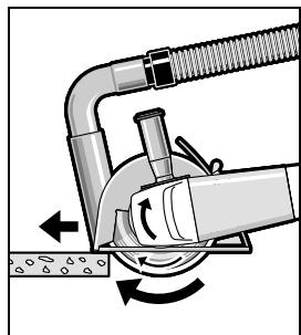
Ligar a ferramenta elétrica e colocá-la com a parte dianteira do carril de guia sobre a peça a ser trabalhada. Empurrar a ferramenta elétrica com avanço moderado, adequado ao material a ser trabalhado.
