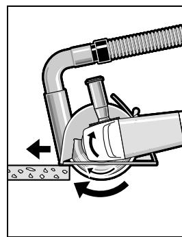
Bật công tắc lên và đưa phần trước của đường cắt lên trên vật gia công. Đẩy nhẹ máy tối cho ăn vào vừa phải, tùy theo loại vật liệu gia công mà thích nghi. Để cắt loại vật liệu đặt biệt rắn, vd., bê-tông có mật độ sỏi cao, đĩa cắt hạt kim cương có thể bị quá nóng và hau quả là bị hư hỏng. Sư cố này được biểu hiện rõ bằng tia lửa bắn ra vòng tròn, quay cùng với đĩa cắt.
