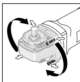
หัวเครื่องสามารถหมุนได้เป็นชั้น ชั้นละ 90° ในลักษณะนี้ เป็นสามารถนำสวิตซ์เปิด-ปิดเบื้องต้นหนึ่งที่ สะดวกต่อการใช้งาน มากกว่าสำหรับสภาพการทำงานที่เฉพาะเจาะจง ด. ย. เช่น สำหรับผู้คนด้วยสาย
