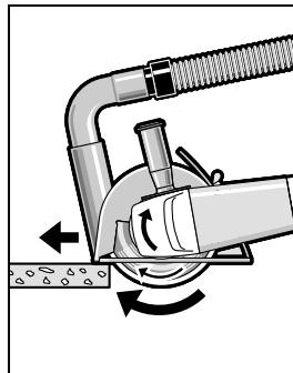
開動電動工具，並把導引裝置的前端放置在工件上。參考工件的物料，適當地施力推進機器。
